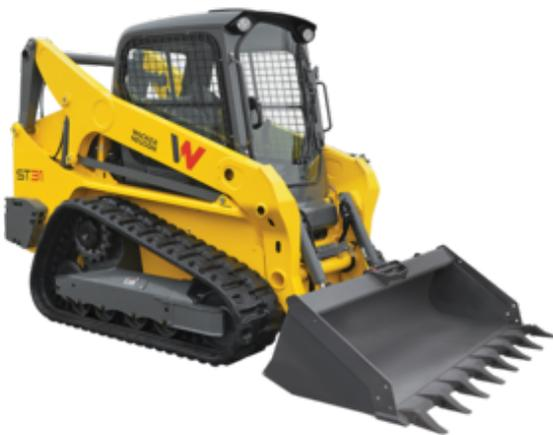
La ST31 assure un maximum d'efficacité grâce à une force de levage de 3 100 lb et une vitesse d'avancement rapide en raison de son poids léger et de sa structure compacte.
