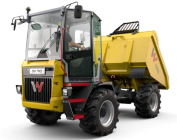
Le DV90 Dual View redéfinit la norme en matière de sécurité de l'opérateur et du chantier, mais aussi de flexibilité et de rentabilité. Le concept Dual View permet de tourner facilement et rapidement le siège avec l'ensemble de la console de siège et de commande à 180 degrés. De cette manière, l'opérateur conserve toujours une visibilité parfaite du sens de marche, et ce, pendant le transport, le chargement et le déchargement.
